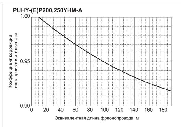
Пример диаграммы для определения коэффициента коррекции холодопроизводительности наружного блока по эквивалентной длине трассы (для модели ПУНУ-P200, 250YHM-A).
