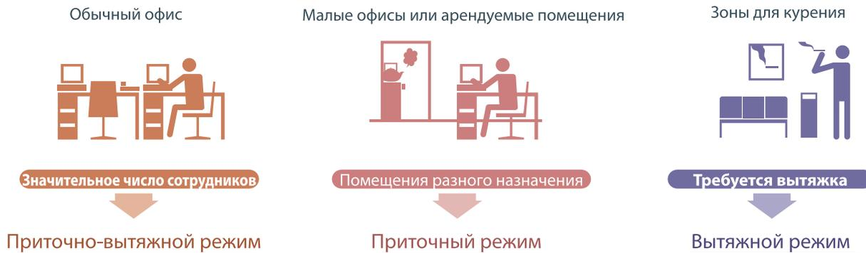
Все модели LGH оснащены режимом "Multi-вентиляция", что позволяет варьировать соотношение приточного и вытяжного воздуха в помещении в зависимости от назначения и использования пространства. Режимы выбираются путем переключения переключателей на плате блока.
