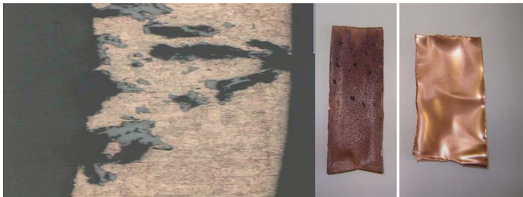
Рис. 3. Исследование среза трубы электронным микроскопом: слева — коррозия, справа — нет коррозии.
