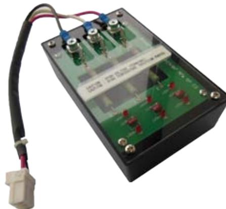
■ Рис. 3. Универсальный прибор для проверки силового модуля инвертора (Inverter Checker)
