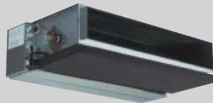
Канальные и некоторые кассетные кондиционеры допускают подмес свежего воздуха. Обычно доля свежего воздуха относительно общего расхода ограничена 10-15%, что обусловлено соотношением между холодопроизводительностью кондиционера и расходом воздуха через него.
