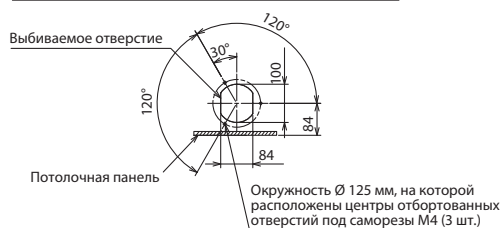
Подробный чертеж отверстий для наружного воздуха (4 отверстия одинаковой формы в углах корпуса)
