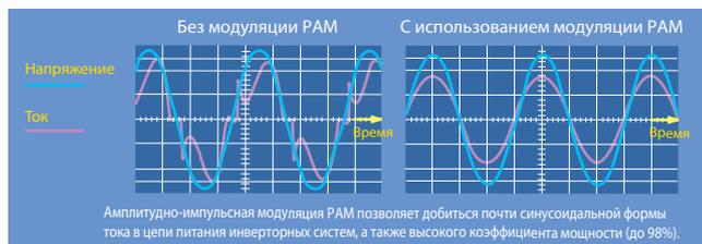
Амплитудно-импульсная модуляция PAM позволяет добиться почти синусоидальной формы тока в цепи питания инверторных систем, а также высокого коэффициента мощности (до 98%).
