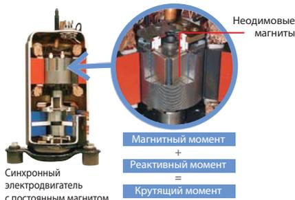
Синхронный электродвигатель с постоянным магнитом
